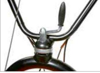
İlgili gidon kolu aracılığıyla dikey ve yatay olarak ayarlanabilen gidon.
