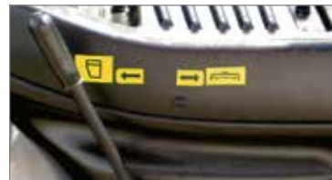
Rahat kullanımlı bir kol vasıtasıyla yükleme tüneline kapatılıp toplama fonksiyonundan malçlama fonksiyonuna otomatik olarak geçilmesini sağlayan "Change over" sistemi.
