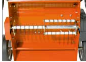
Bilyeli rulmanlar ve gresleme sistemi üzerine monte edilmiş 28 yüzer bıçaklı rotor.
