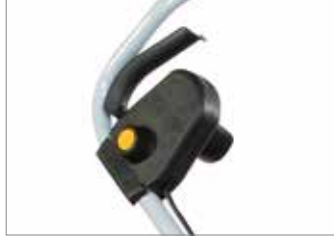
Bıçak, gidon üzerine yerleştirilmiş rahat bir kol aracılığıyla çalıştırılır.
