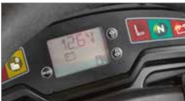
LCD ekran, çalışma saatleri, akü voltajı, depo seviyesi gibi çim biçme traktörlerinin ana bilgilerinin hızlı ve anında görüntülenmesini sağlar.
