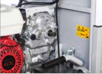
2.100 dev/dak hızında bağımsız güç çıkış ünitesi.
