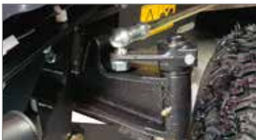
En ağır işlere ve olası çarpışmalara karşı dayanıklılık sağlamak için dökme çelikten yapılmış ön dingil.
