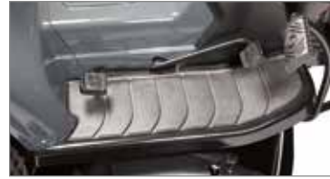
Hız ayarı direkt olarak hidrostatik transmisyona etki eden çiftli bir pedalla yapılan yandan tahliyelili yeni bahçe traktörleri Bu çözüm sayesinde, kullanım esnasında vites yönünü değiştirmek ve hızı kontrol etmek mümkündür.
