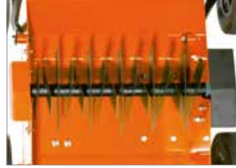
15 Sabit bıçaktan oluşan rotor.
