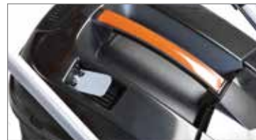
Çim sepeti "dolu" göstergesi sepetin boşaltılması gerektiğini bildirir, böylece seviye kontrolü için çalışmaya ara verme zorunluluğunu ortadan kaldırır ve fazla dolulardan dolayı çimlerin taşması engellenir.
